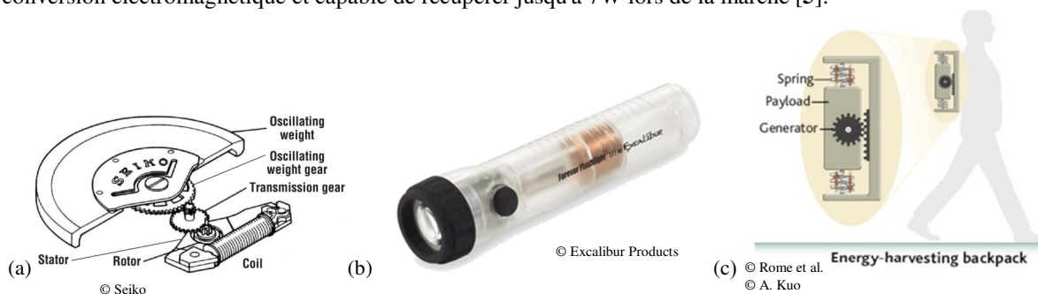
Figure 6. (a) Récupérateur d'énergie dans une montre ©Seiko [6] (b) système de récupération d'énergie inertielle pouvant être placé dans une poche ©Excalibur Products [7] et (c) sac à dos récupérateur d'énergie [5]
