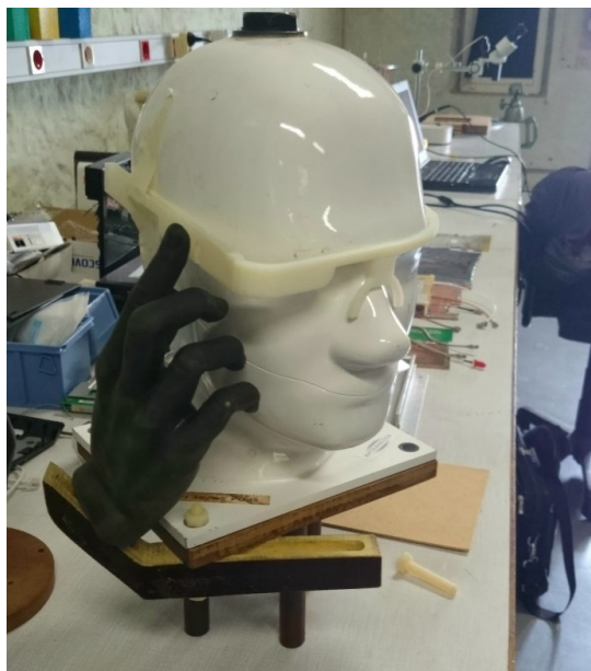
Fig. 29- Dispositif en cours de développement (Orange Labs) pour des mesures en présence de la main de l'utilisateur
