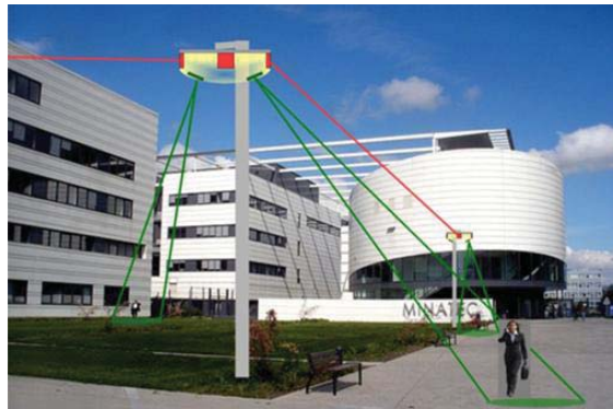
Figure 2: Illustration de réseau hétérogène avec point d'accès (vert) et backhaul (rouge)
