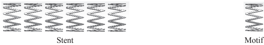
Figure 6 : Réplique du stent simulé sous CST MWS
