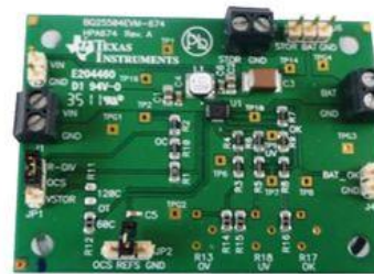
c. Convertisseur DC/DC élévateur (BQ25504 de TI)
